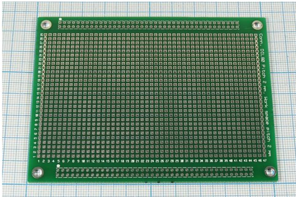
Размер 101мм\* 76мм, шаг между отверстиями 2 мм. Площадки квадратные. Два крайних ряда по вертикали соединены в линию. Остальные отверстия не соединены между собой. Диаметр отверстий – 0.9мм. Обе стороны платы одинаковы. По углам имеются крепежные отверстия. Отверстия металлизированные. Материал FR-4. Толщина 1.6мм.
