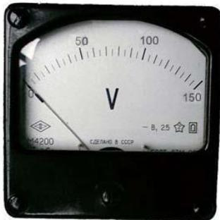
Вольтметр М4200 предназначен для измерения напряжения в сетях постоянного тока. Прибор представляет собой щитовой малогабаритный вольтметр магнитоэлектрической системы. Измерительный механизм прибора состоит из магнитной системы (обойма, магнитопровод), отсчетного устройства (циферблата, стрелка) и подвижной части с креплением на кернах.
