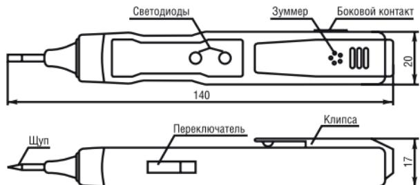
Применяется для контактного определения наличия напряжения, целостности цепей приборов и бесконтактного определения наличия электромагнитных полей.
