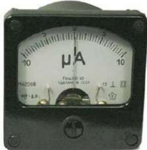
Микроамперметр М42008 предназначен для измерений постоянного тока.
