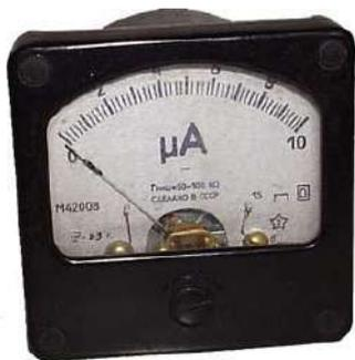
Микроамперметр М42008 предназначен для измерений постоянного тока. По условиям механических воздействий приборы относятся к вибро- и тряскопрочным.
