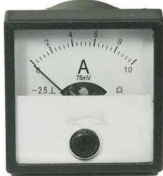
Амперметр CG-40 предназначен для измерения тока в цепях постоянного тока. Прибор представляют собой щитовой малогабаритный амперметр магнитоэлектрической системы с подвижной рамкой и внутрирамочным магнитом.
