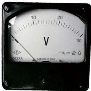
Вольтметр М4233 предназначен для измерения напряжения в электрических цепях постоянного тока. Вибропрочные, тряскопрочные. Герметичные.
