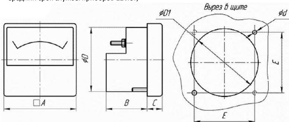
где А - 80мм, В - 36мм, С - 14мм, Д - 70мм, Д1 - 77,5мм, д - 3,4мм, Е - 68,2мм;
