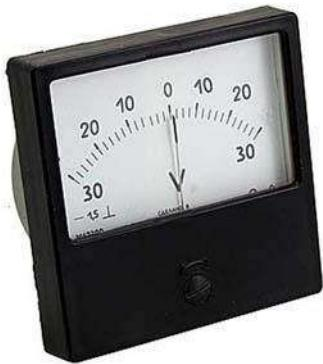
Вольтметр М42300 предназначен для измерений напряжения в электрических цепях постоянного тока. Приборы представляют собой щитовые приборы магнитоэлектрической системы с внутрирамочным магнитом; Измерительный механизм прибора состоит из магнитной системы (обойма, магнитопровод), отсчетного устройства (шкала, указатель) и подвижной части на кернах;
