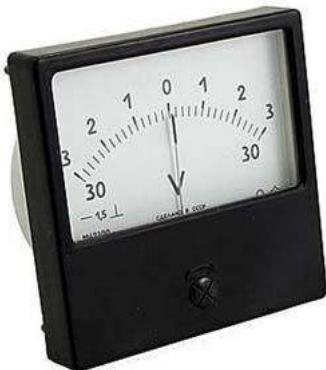
Вольтметр М42300 предназначен для измерений напряжения в электрических цепях постоянного тока. Приборы представляют собой щитовые приборы магнитоэлектрической системы с внутрирамочным магнитом; Измерительный механизм прибора состоит из магнитной системы (обойма, магнитопровод), отсчетного устройства (шкала, указатель) и подвижной части на кернах;
