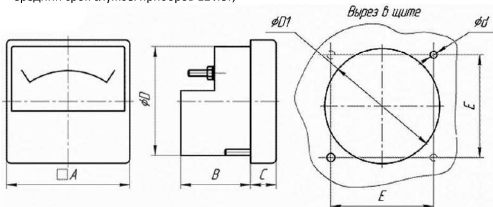
где А - 80мм, В - 36мм, С - 14мм, D - 70мм, D1 - 77,5мм, d - 3,4мм, Е - 68,2мм;
