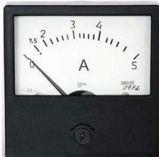
Амперметр Э8030 предназначен для измерения тока в цепях переменного тока на передвижных и стационарных объектах.
