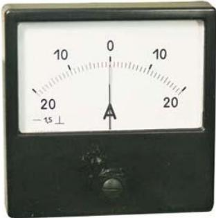
Амперметр М42300 предназначен для измерений тока в электрических цепях постоянного тока. Приборы представляют собой щитовые приборы магнитоэлектрической системы с внутрирамочным магнитом; Измерительный механизм прибора состоит из магнитной системы (обойма, магнитопровод), отсчетного устройства (шкала, указатель) и подвижной части на кернах;
