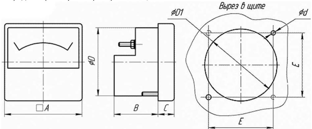
где А - 80мм, В - 36мм, С - 14мм, D - 70мм, D1 - 77,5мм, d - 3,4мм, E - 68,2мм;
