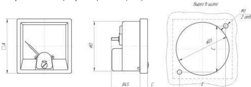
где А - 40мм, В - 36мм, С - 12мм, D - 36,1мм, D1 - 37,5мм, d - 3мм, Е - 32мм;
