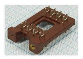
Плата предназначена для объемного монтажа радиоэлектронных устройств. Имеет 18 пронумерованных контактов (10 с одной и 8 с обратной стороны). Для крепления к шасси имеет две металлические вставки с резьбой МЗ. Рабочее положение – вертикальное.
