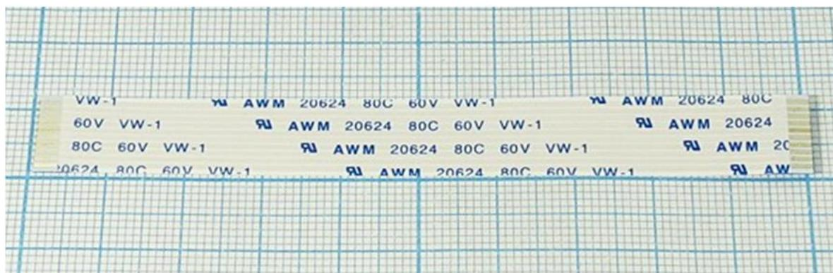
Шлейф представляет из себя гибкий соединитель длиной 100 мм и шириной 11 мм. Количество контактов 10, шаг 1 мм.
